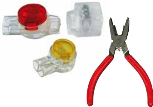
Connecteurs type AVS pour conducteurs courants faibles de diam. 0,4 à 0,9 mm, transparents, remplis de graisse silicone, auto-dénudants, diamètre sur isolant jusqu'à 2,00 mm
